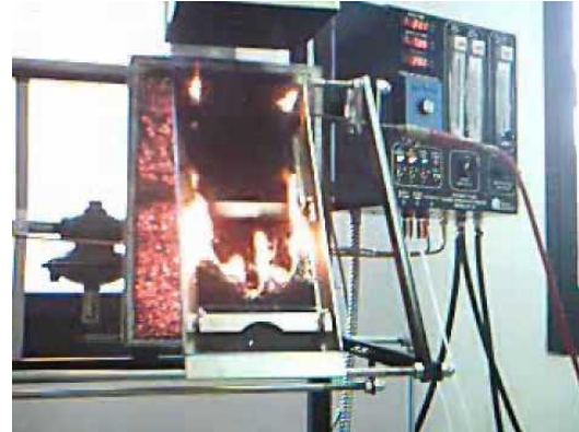
ASTM E162 “radiant panel”
